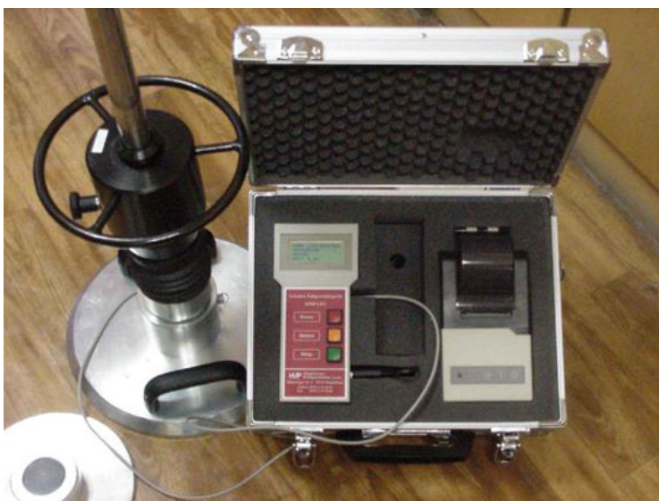
Fot. 3. Przykładowy zestaw do badania płytą dynamiczną
