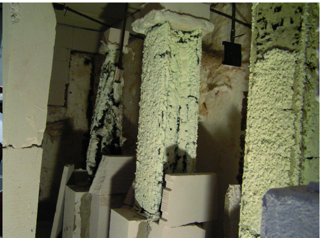
Fot. 12. Widok farby pęczniejącej na elementach stalowych po badaniu odporności ogniowej. Autor: archiwum ITB
