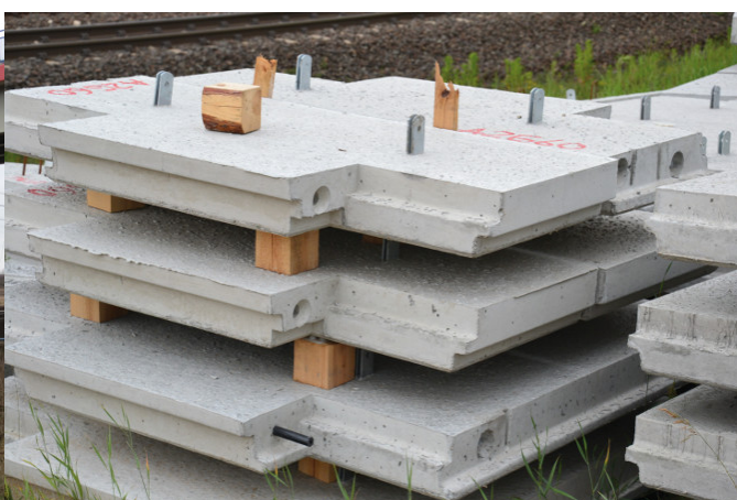
Fot. 6. Panele prefabrykowane ściany oporowej
