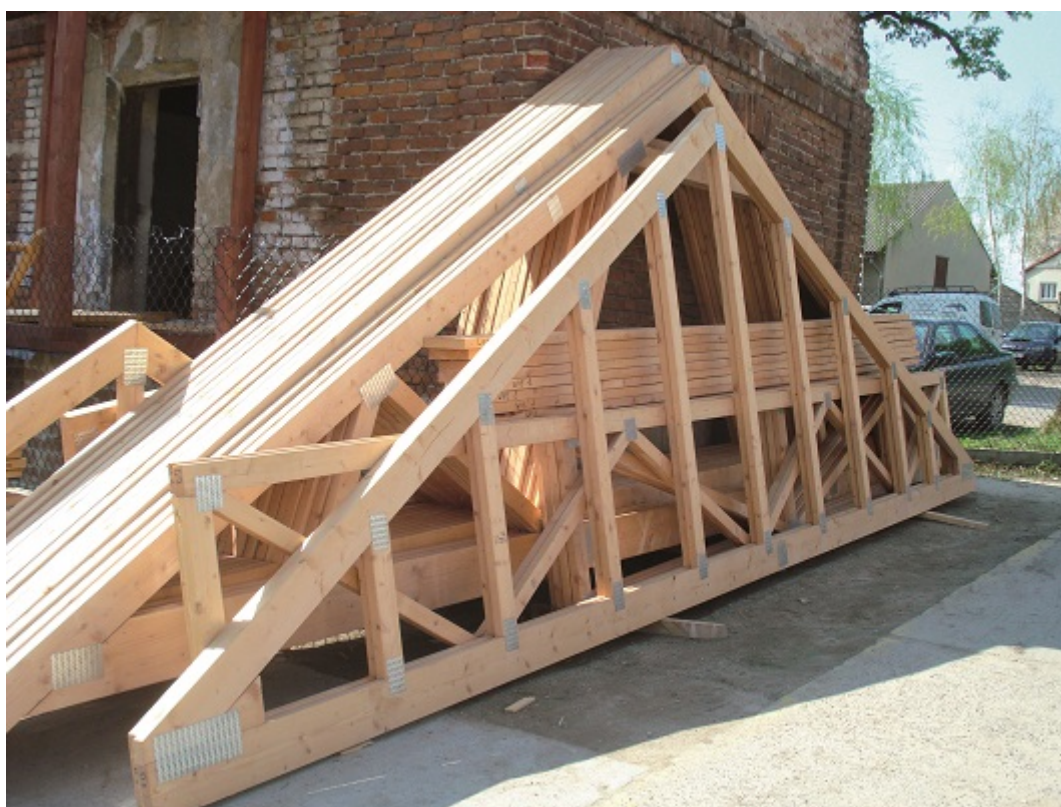
prostych prefabrykacji (dźwigar kratowy na płytki kolczaste) (źródło autora)
