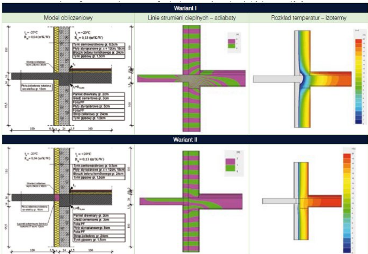
Tablica 3. Analiza cieplno-wilgotnościowa złącza budowlanego – połączenie ściany zewnętrznej z płytą balkonową [18]
