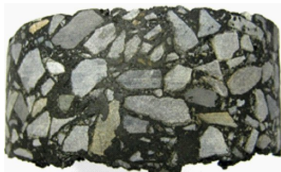
Rys. 6. Szkielet mineralny w mastyksie grysowym SMA 11
