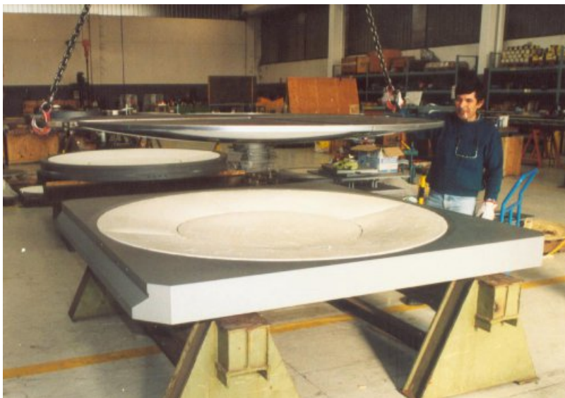
Fot. 4. Montaż największego w Polsce łożyska soczewkowego o nośności 110 MN
