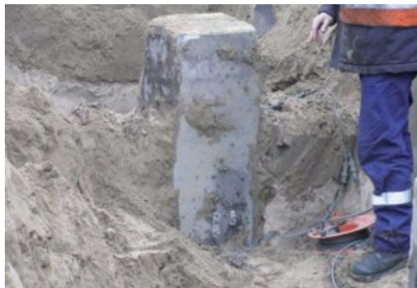
Fot. 7. Czujniki do pomiaru odkształceń i przyspieszeń w badaniu dynamicznym pala
