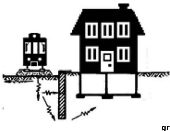
Rys. 14. Schemat przegrody wibroizolacyjnej w
