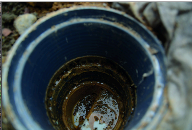
Fot. 2. Zakamieniony pierścień „przedłużki” (fot. autora)
