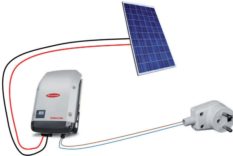
Rys. 1. Poglądowy schemat instalacji on-grid (schemat własny autora)
