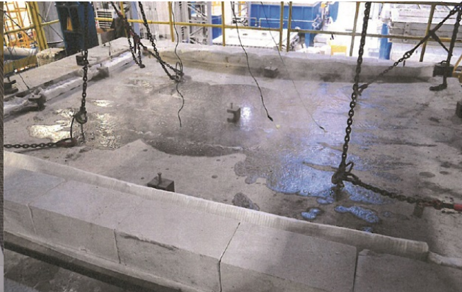
Fot. 2c. Strona nienagrzewana żelbetowej płyty o grubości 15 cm. Oddziaływanie standardowe od dołu. T = 60 min
