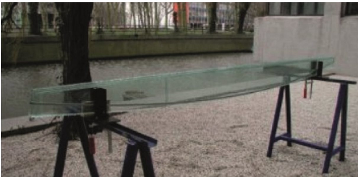
Fot. 1. Różne rozwiązania hybrydowych belek stalowo-szklanych [1, 8, 9]
