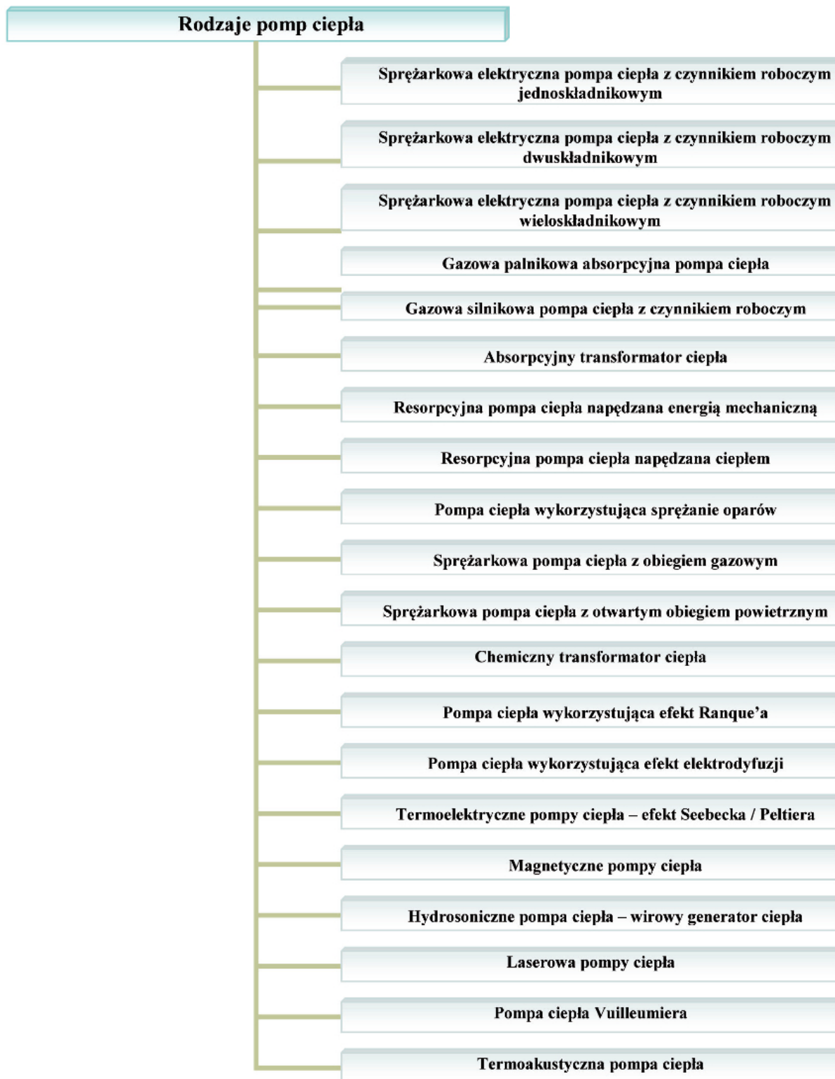
Rys. 3. Rodzaje pomp ciepła ze względu na zasadę działania
