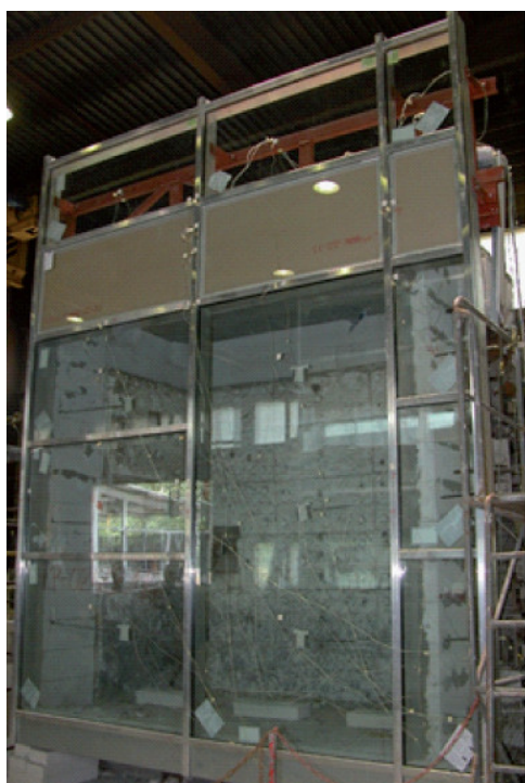
Fot. 6. Ściana słupowo-ryglowa nagrzewana od wewnątrz: a) przed badaniem, b) po badaniu
